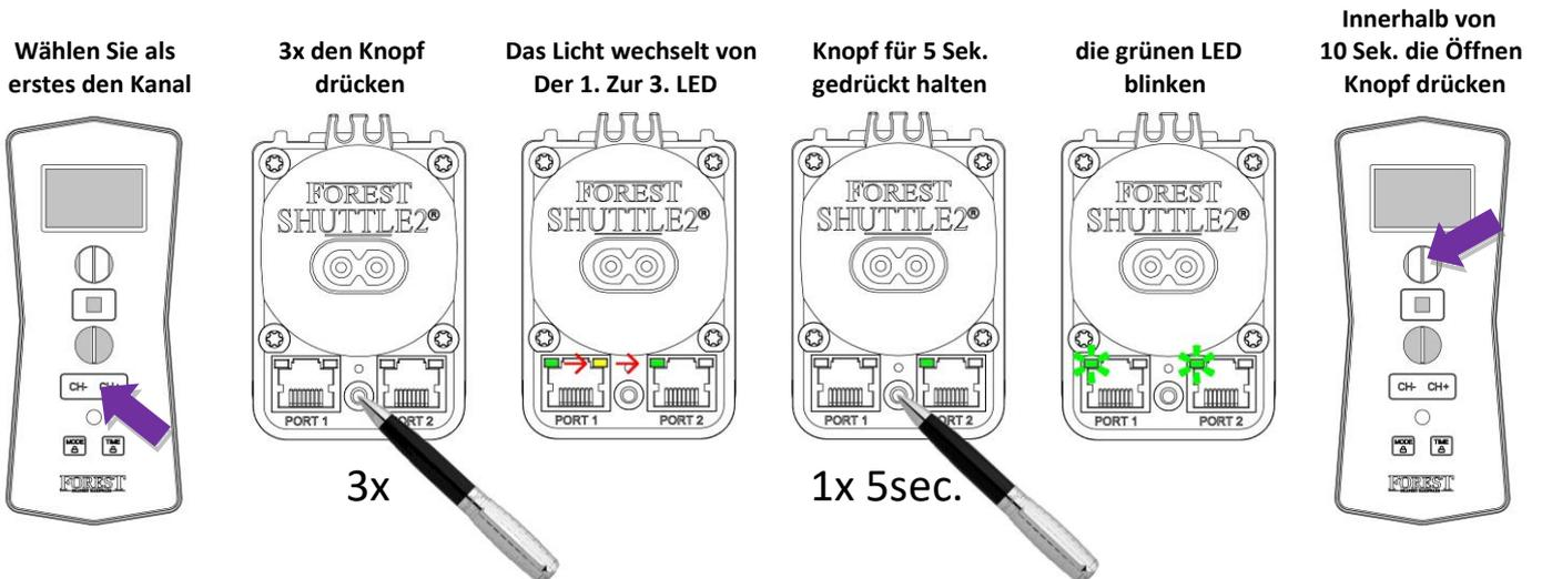
Jetzt können Sie die Endpositionen einstellen, indem Sie per Hand den Überzugswagen anschieben (Touch) bis der Vorhang geschlossen ist. Jetzt schieben Sie den Überzugswagen wieder auf, jetzt blinkt die gelbe LED, Sie haben 10 Sekunden Zeit die Parkposition des Vorhangs zu verändern. Danach erlischt die gelbe LED, und die Endpositionen sind gespeichert.
